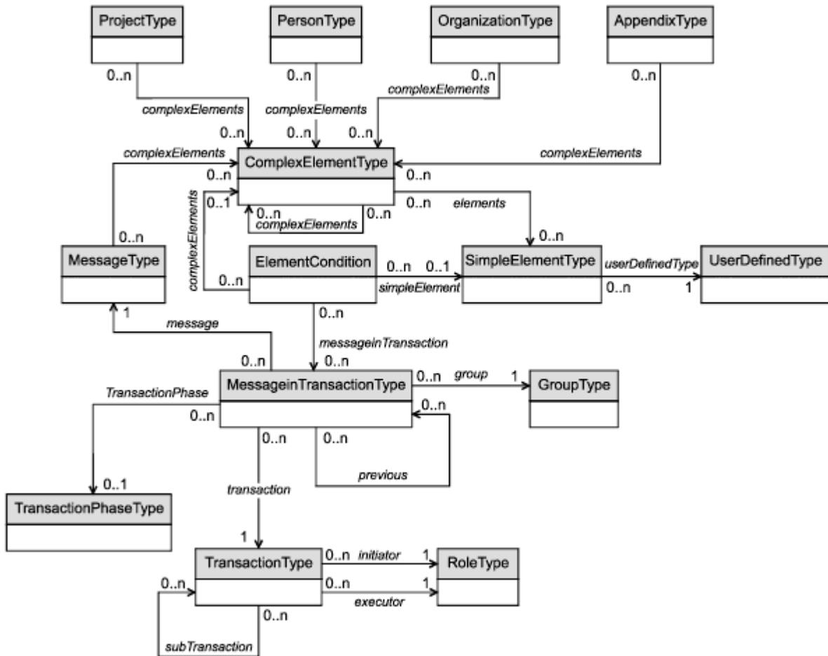
Рисунок 7 - Типы и ссылки схемы структуры взаимодействия Приложение А (обязательное)
