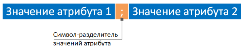
Рисунок 4.3.2.2 – Схема формирования перечислений в значениях атрибутов элементов
