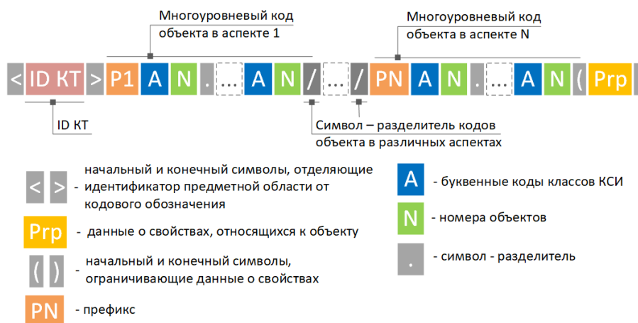
Рисунок 6.8.1 – Схема формирования полного составного кода объекта
