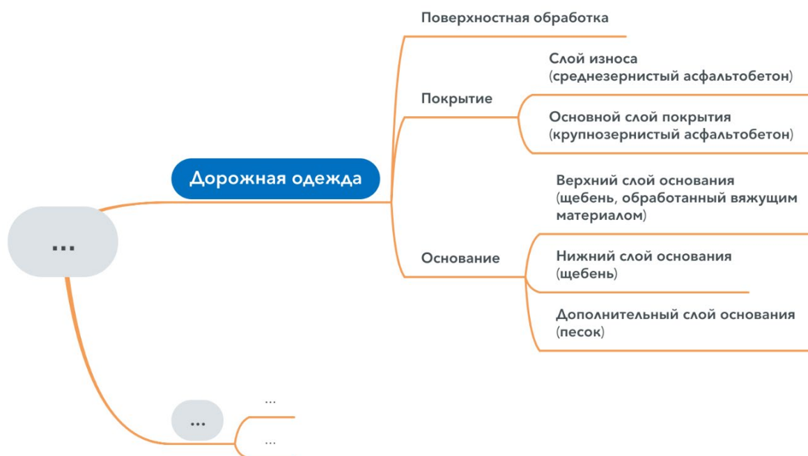
Рисунок 4.1.1.5 – Пример системного представления объекта «дорожная одежда» в качестве подсистемы для объекта «автомобильная дорога»
