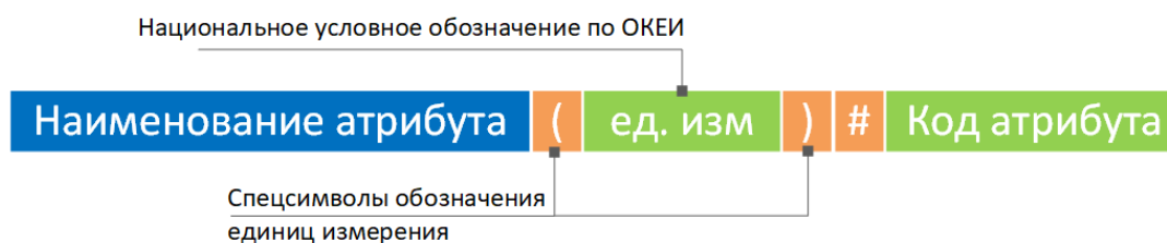
Рисунок 4.3.2.1 – Схема формирования значений для количественных атрибутов с единицами измерения
