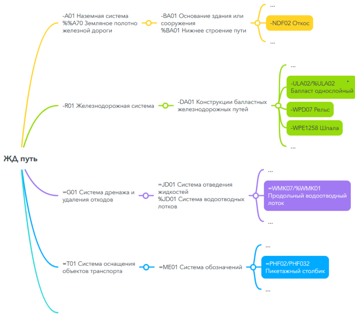
Рисунок Г.4.2 – Системная декомпозиция для фрагмента ЖД пути (см. рисунок Г.4.1)
