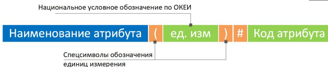
Рисунок 4.2.11 – Схема формирования значений для количественных атрибутов с единицами измерения
