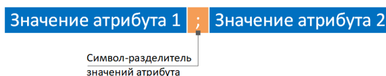
Рисунок 4.2.12 – Схема формирования перечислений в значениях атрибутов элементов
