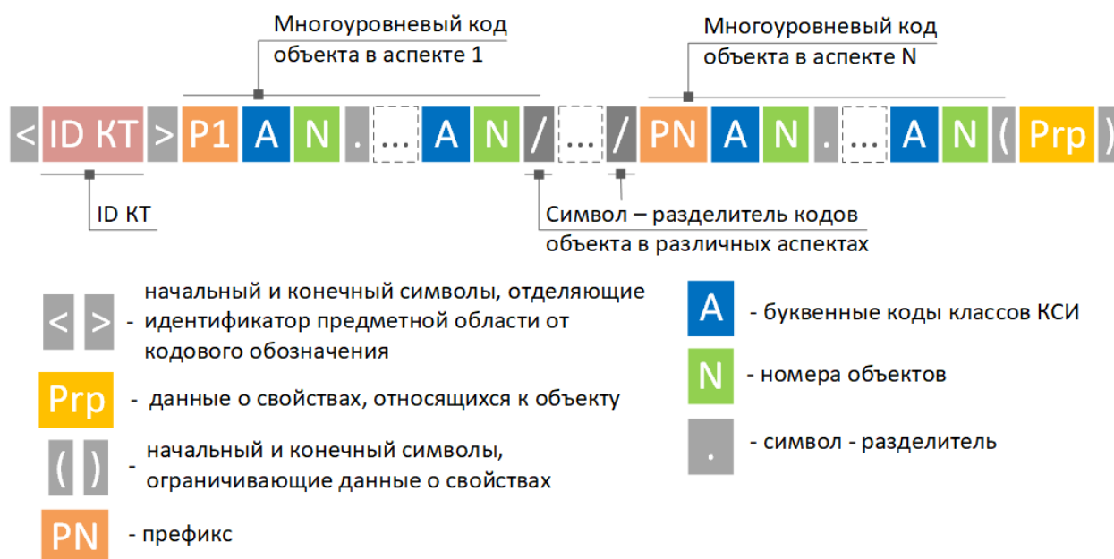
Рисунок 6.8.1 – Схема формирования полного составного кода объекта
