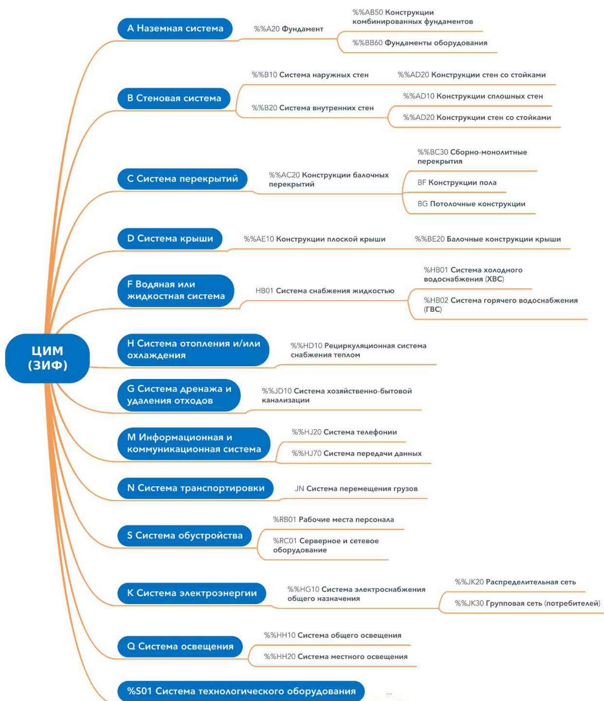
Рисунок А.1 – Пример декомпозиция ОКС на отдельные системы и подсистемы (разработка структуры ЦИМ)
