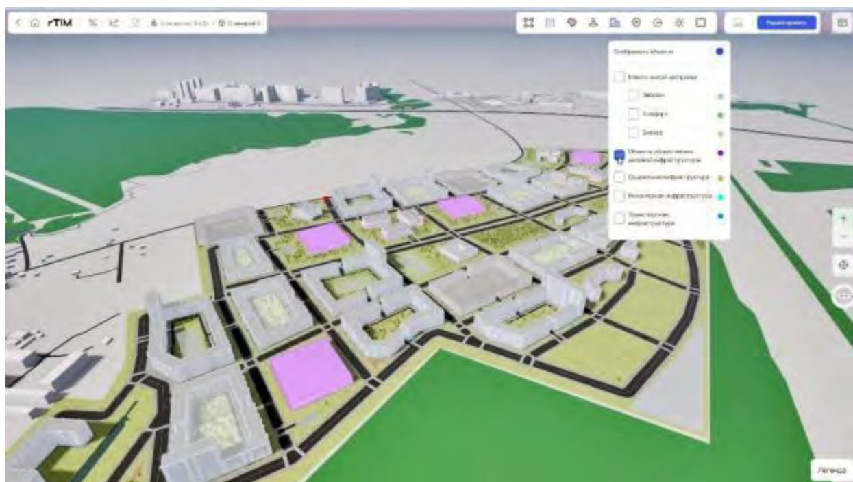
Рис. 2. – Пример генерации варианта концепции КРТ по среднеэтажной модели стандарта КРТ Минстроя на платформе rTIM
