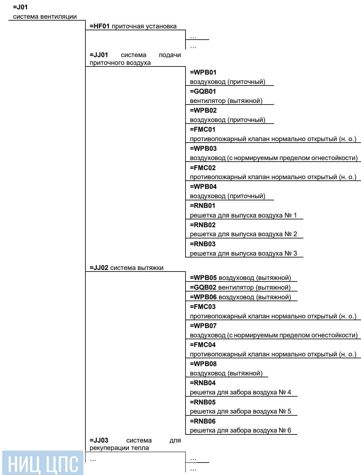
Рисунок Б.2.2 – Фрагмент схемы иерархической структуры представления системы вентиляции машинного цеха
